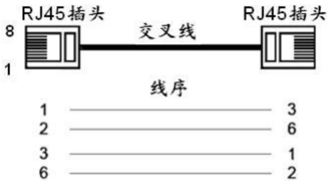
图 12 10/100Base-T(X) RJ45 插头交叉线互连
