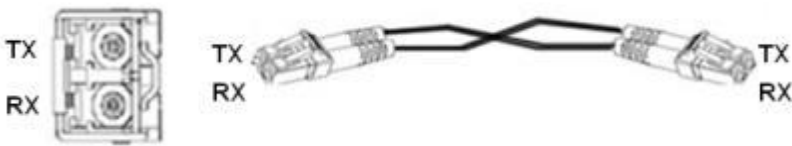
图 9 千兆SFP 光模块接线图
