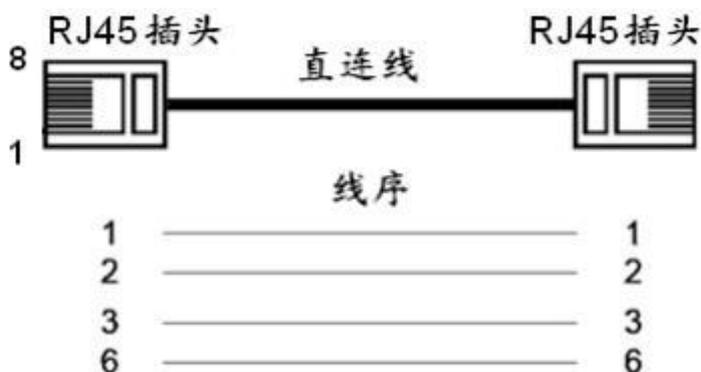
图 11 10/100Base-T(X) RJ45 插头直连线互连
