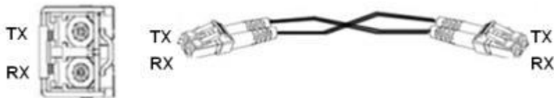
图 9 千兆SFP 光模块接线图
