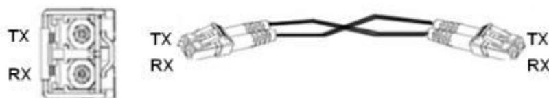
图 9 千兆SFP 光模块接线图
