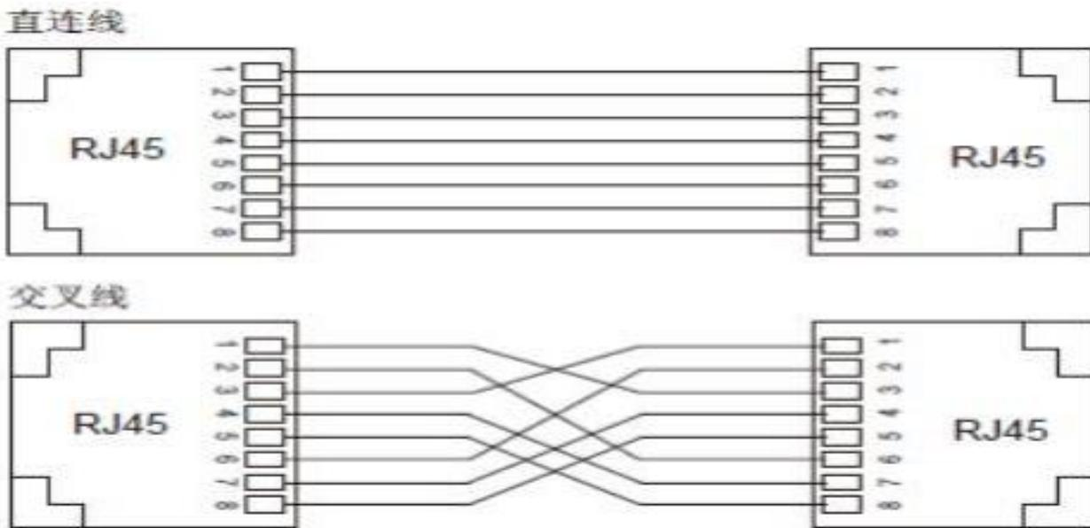
图 7 10/100/1000Base-T(X) RJ45 接头直连线、交叉线互连
