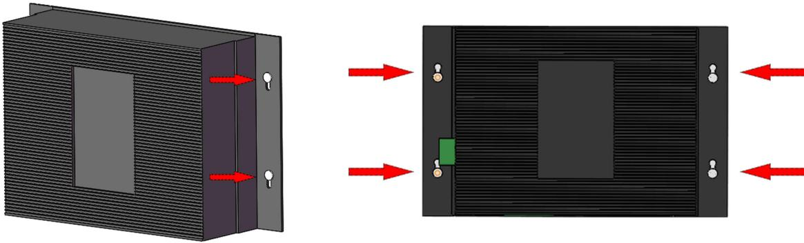
2. 通过螺钉将设备固定到墙面上。
