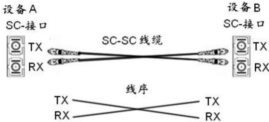
图 13 100Base-FX 接线图
