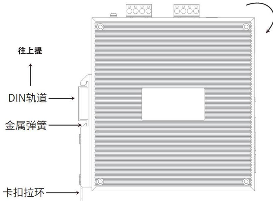
图 7 卡轨式拆卸图
