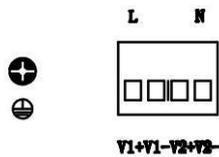
图 15 4芯 5.08mm 间距插拔式接线端子（插座）
