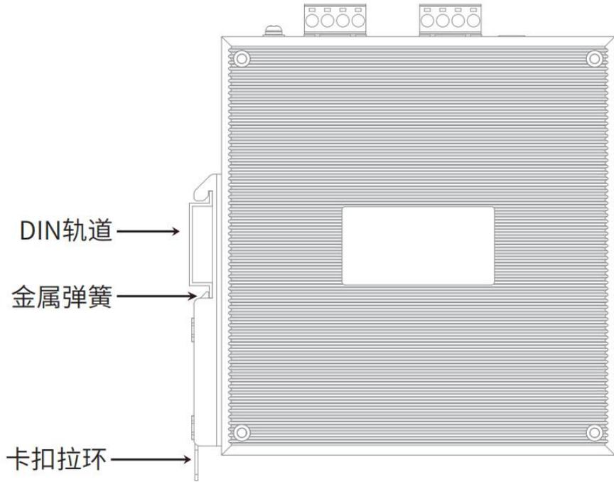
图 6 卡轨式安装图
